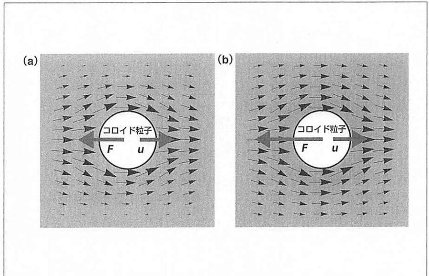
〈図1〉 流体中でコロイド粒子を速度  $u$  で動かした場合の流速場
