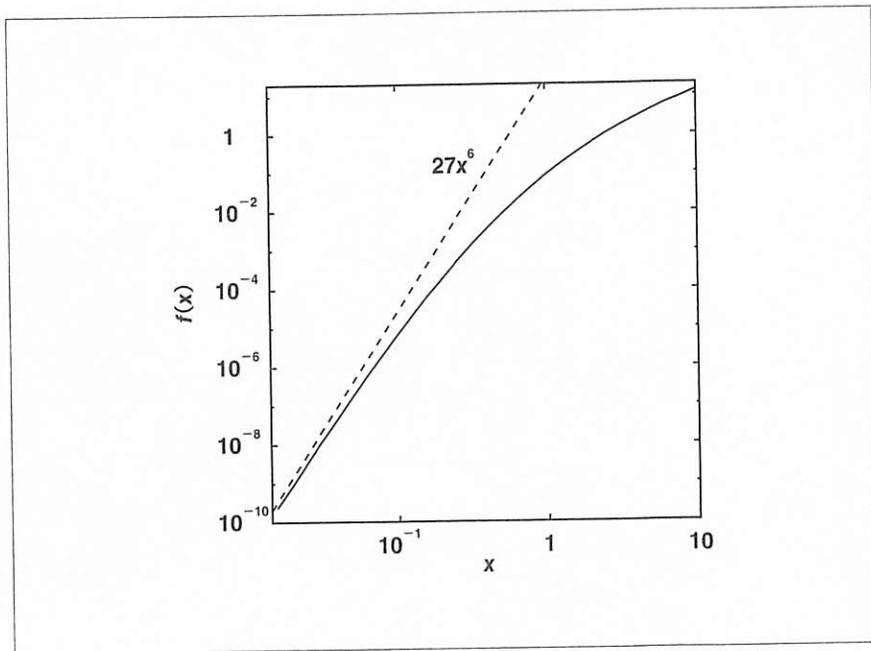
〈図2〉 ストークスの抵抗法則の補正
